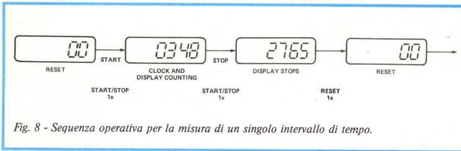
Fig. 8 - Sequenza operativa per la misura di un singolo intervallo di tempo.
